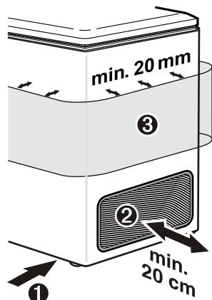
③ Нельзя заставлять наружную поверхность прибора. Минимальное расстояние вокруг прибора должно составлять 20 мм для обеспечения достаточной теплоотдачи.
