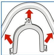
2. Извлеките шланги из колен для фиксации и снимите колена.
