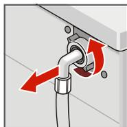
Снимите шланг со спинки прибора.
