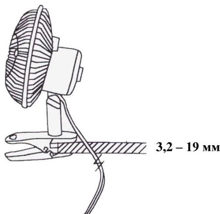
С помощью клипсы (зажима) прибор может быть установлен на плоской поверхности, толщиной 3,2 – 19 мм. Перед тем, как установить вентилятор с помощью клипсы, убедитесь, что поверхность достаточно прочная и устойчивая.
