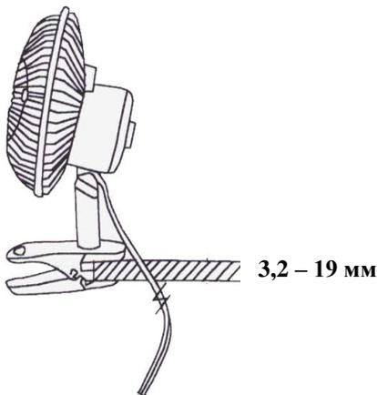
За допомогою кліпси (прищіпки) прилад може встановлюватися на плоскі поверхні, товщиною 3,2 – 19 мм. Перед тим, як встановлювати вентилятор за допомогою кліпси, переконайтесь у тому, що поверхня достатньо міцна та стійка.
