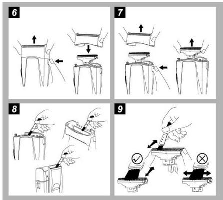
оба конца и потянув вверх (рис. 7). Используйте длинную щетину щеточки для чистки сетки бритвенной головки, корпуса бритвы и триммера (рис. 8). Используйте короткую щетину щеточки для чистки внутренних лезвий. Внутренние лезвия чистите в направлении, указанном на рис. 9. На рис. 9 также показано, как запрещается чистить лезвия, т.к. это может повредить внутренние лезвия и снизить качество бритья. Не используйте короткую щетину для чистки бритвенной головки.
